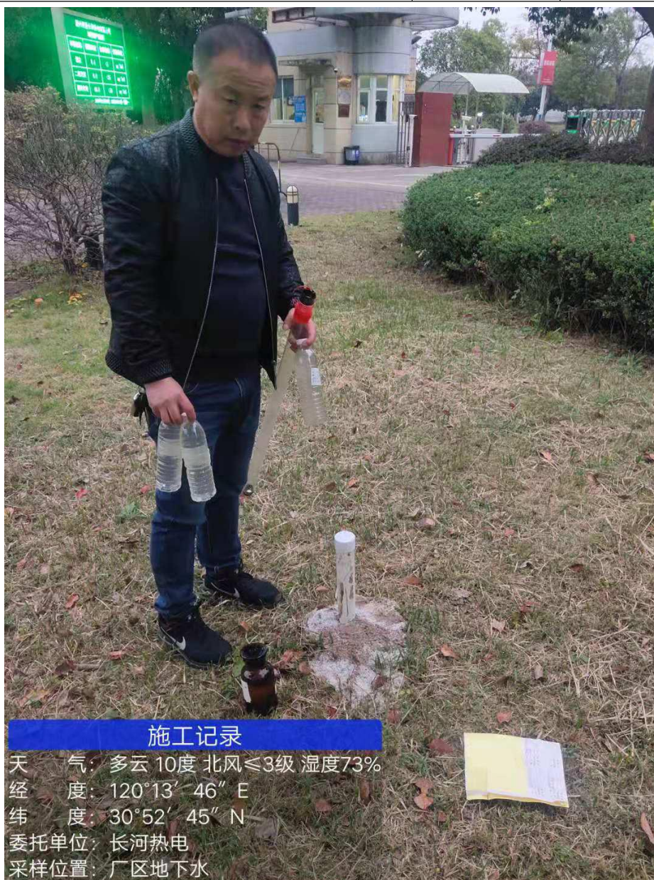
图 7.3-1 厂区地下水采样
