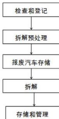
图 2-1 项目报废汽车回收拆解作业流程框图
