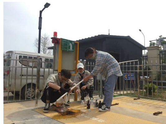
污水总排口检测
